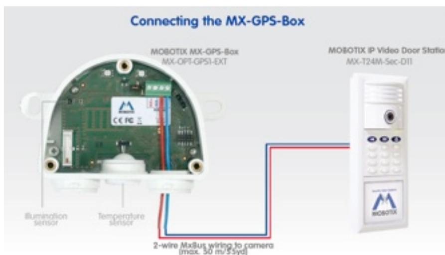
**MX-GPS-Box**により、カメラ設置位置を特定でき、Googleマップとの連動が可能となっています。また、カメラ設置位置の温度を把握でき、GPS情報により、カメラの時間を正確に保つことができます。**MOBOTIX**カメラには、タイムサーバー機能があるため、1台のカメラと1台の**MX-GPS-Box**を接続することで、同じネットワーク上にある**MOBOTIX**カメラにも、正確な時間で時間同期を可能とします。また、移動体にカメラを取り付けた場合には、その移動体が現在どの位置にあるのかを、マップで把握し、指定の範囲から逸脱した場合には、アラームを発信することができます。
