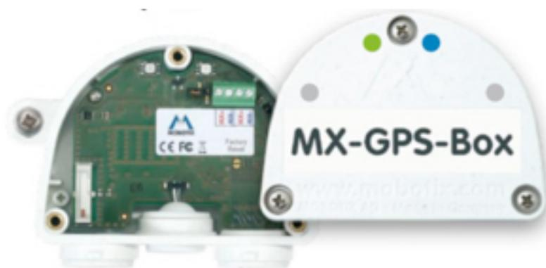
**MX-GPS-Box**は、**MOBOTIX**カメラのシステムの有用性を高めるものです。統合されたセンサーにより、外気温、照度、速度、正確な時刻、そして、位置情報を接続したカメラに提供し、それぞれに変化が見られた場合にアラームを発信することができます。**MX-GPS-Box**は、最大50メートルまで2線式ケーブルで接続し、**MxBus** (**MOBOTIX**カメラ**D14**と**T24**に統合されている**MOBOTIX**オリジナルの伝送方式) 経由で統合され、動作に必要な電力 (1ワット以下) も供給されます。
